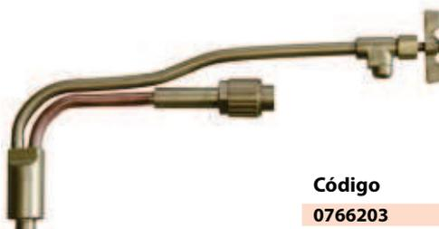
El adaptable de corte está equipado con una válvula rápida de bola para manipular el Oxígeno de corte. Gracias al tubo de cobre de alta calidad usado para suministrar la mezcla de calentamiento, ofrece una mayor resistencia térmica. Tiene a su disposición una completa variedad de boquillas para cortar acero de hasta 300 mm.
