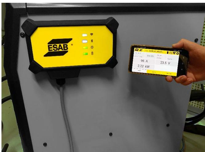
*Conexión intuitiva y configuración mediante una aplicación móvil.*
