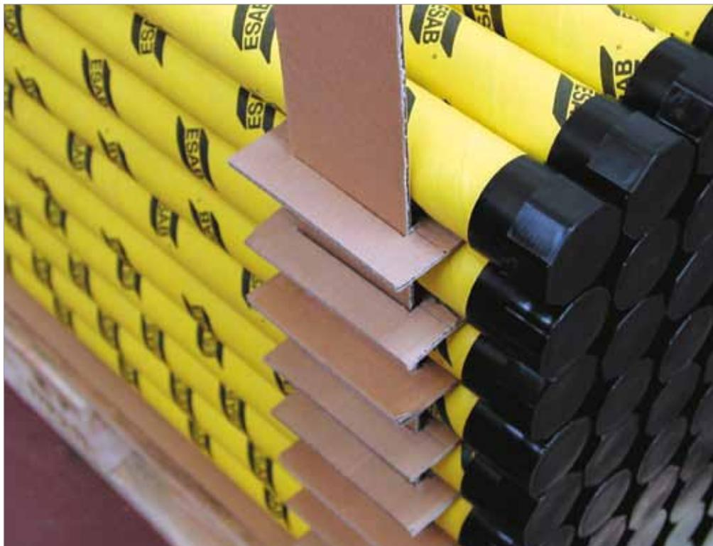
Los hilos macizos MIG/MAG, varillas TIG e hilos y bandas para SAW deben almacenarse en un lugar seco en el paquete original libre de daños. Evitar el contacto con el agua proveniente de lluvias o de la condensación de humedad sobre los hilos fríos. Con el fin de evitar la condensación, mantenga los hilos en sus embalajes originales y, si fuera preciso, deje que se calienten hasta alcanzar, al menos, la temperatura ambiente antes de abrir el paquete.
