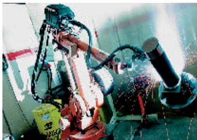
T.M.C. Cadelbosco Sopra, Italia, suministra componentes a conocidos fabricantes de grúas en Europa, incluida a su compañía hermana Basket. TMC opera con cuatro estaciones de soldadura robotizadas MAG que emplean 250 kg Marathon Pacs que contienen AristoRod 12.50 y 13.29 para proporcionar una alimentación de hilo sin problemas, una menor cantidad de proyecciones así como una reducción notable del mantenimiento del sistema de alimentación.
