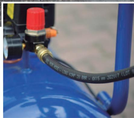
Refuerzo hilos sintéticos de alta resistencia
